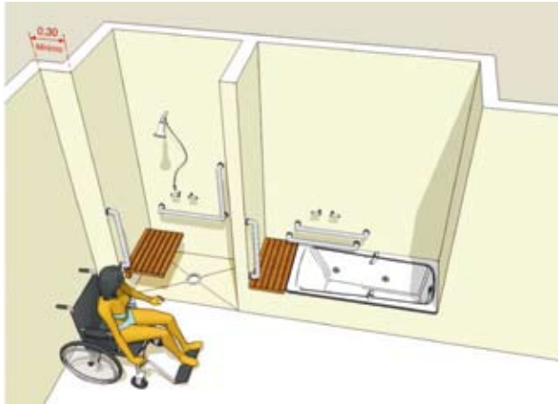
Figura 101 - Vista de banho com chuveiro e banheira
