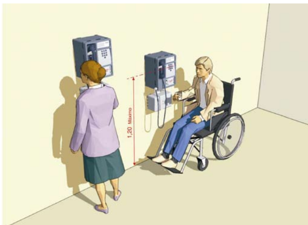
Figura 103 - Altura de telefone acessível
