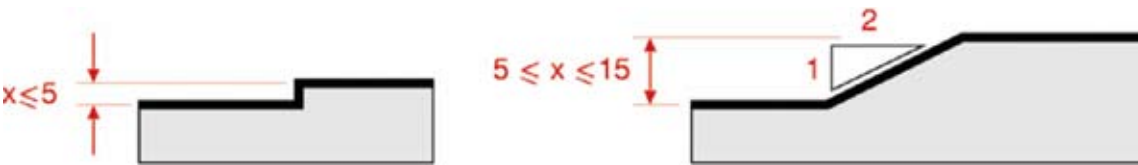
Figura 76 (A e B) – Tratamento de desníveis
