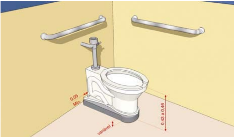
Figura 97 - Altura de bacia sanitária acessível
