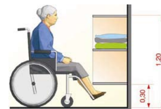
Figura 127 – Altura de utilização de armários
