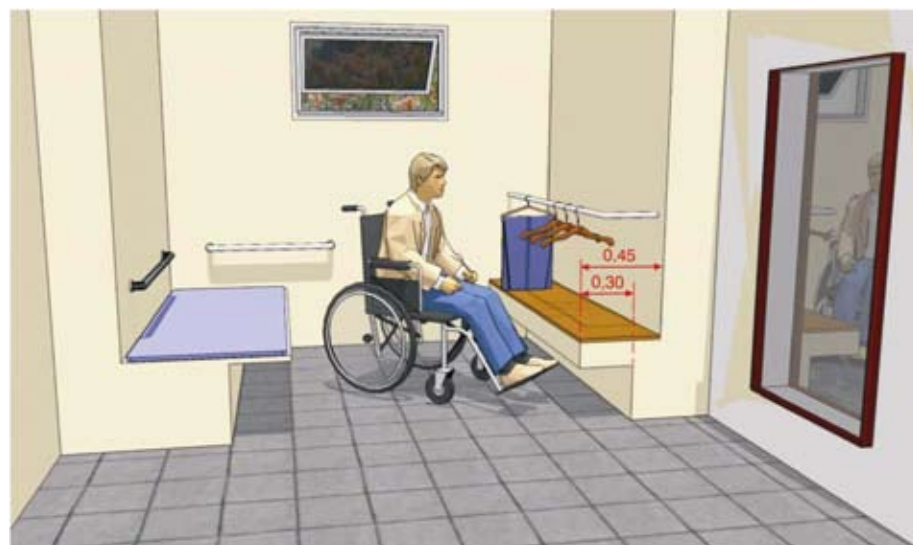
Figura 123 – Vista de vestiário acessível
