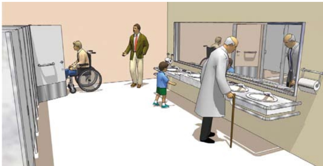
Figura 88 – Vista de um sanitário acessível
