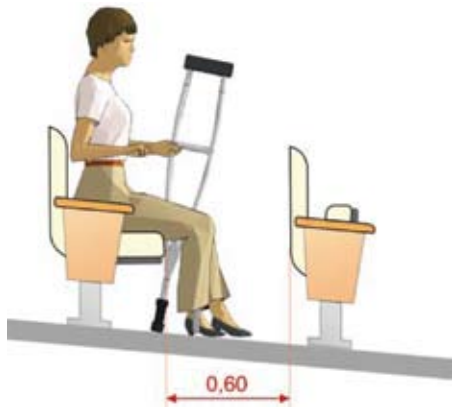
Figura 114 – Espaçamento livre frontal
