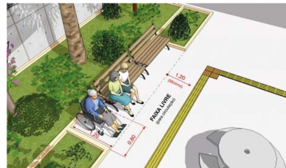
Figura 72 – Espaço para pessoa em cadeira de rodas (Módulo de Referência)
